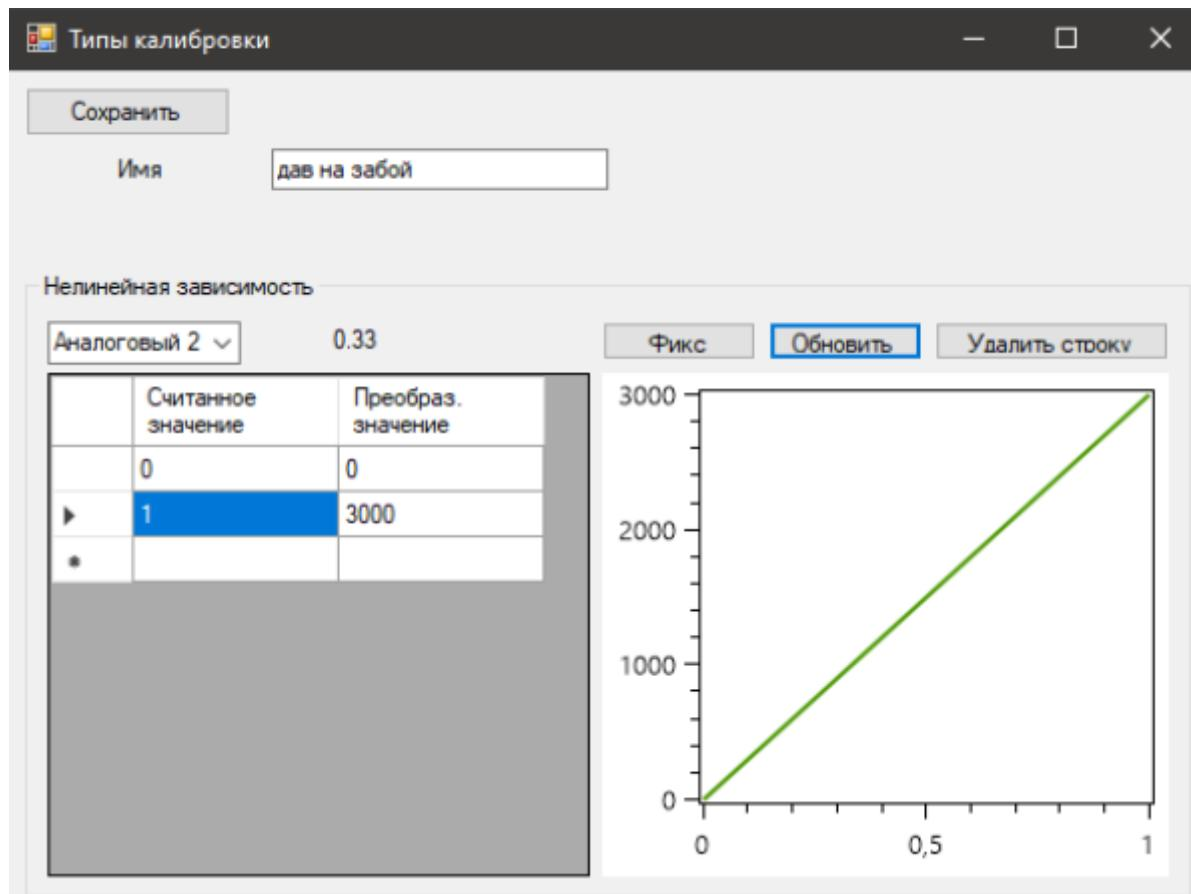
Для создания нового типа датчика необходимо ввести название и выбрать тип зависимости. Для нелинейной зависимости отображается график, построенный по введенным точкам.
