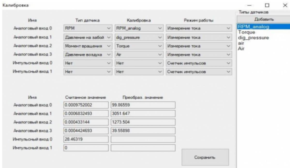
Чтобы откалибровать датчик необходимо создать новый тип датчика, нажав по кнопке «Добавить». Откроется окно с выбором типа зависимости.
